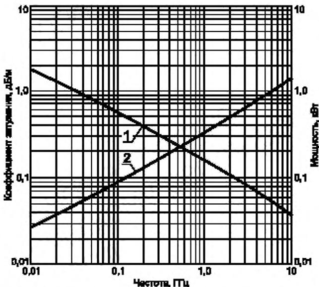
1 — допустимая мощность  $P$  на входе при температуре 40 °С и коэффициенте стоячей волны напряжения, равном 1;
