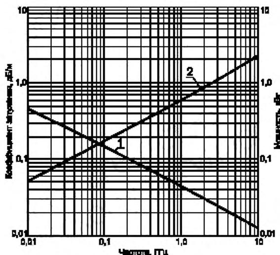
1 — допустимая ѹюшность  $P$  на входе при температуре 40 °C и коэффициенте стоячей волны напряжения, равном 1;
