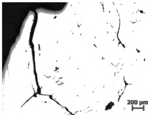
б — микроструктура в зоне дефекта с неметаллическими включениями, 50 x
