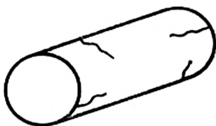
б — дефект на сортовом прокате
