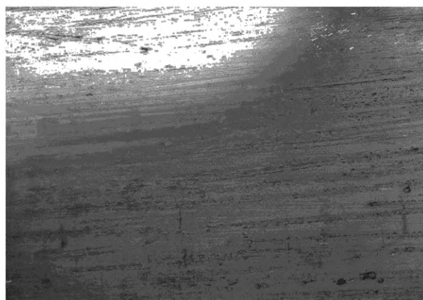
Рисунок Б.53 — Цвета побежалости (внешний вид) (термин 3.3.33)
