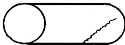
в — дефект на сортовом прокате в виде единичной трещины
