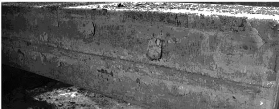
а — внешний вид дефекта на непрерывнолитой заготовке
