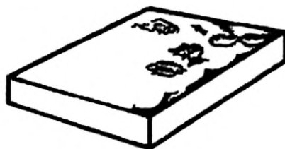
Рисунок 67 — Пятна слипания сварки
