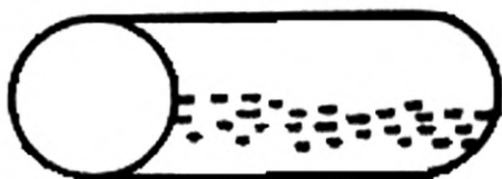
б — дефект на сортовом прокате
