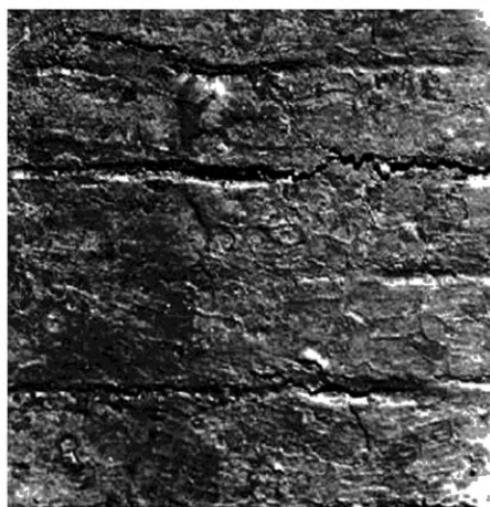
б — внешний вид дефекта на грани заготовки
