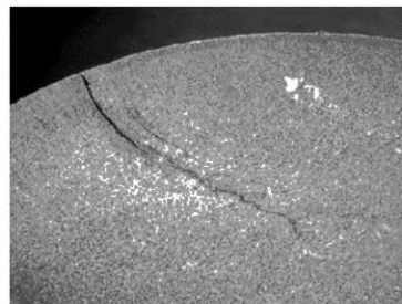
г — вид дефекта в поперечном сечении макротемплета
