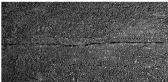
в — вид дефекта на поверхности горячекатаного проката
