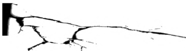
б — вид дефекта на микрошлифе до травления, 50 х
