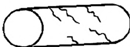
б — дефект на сортовом прокате
