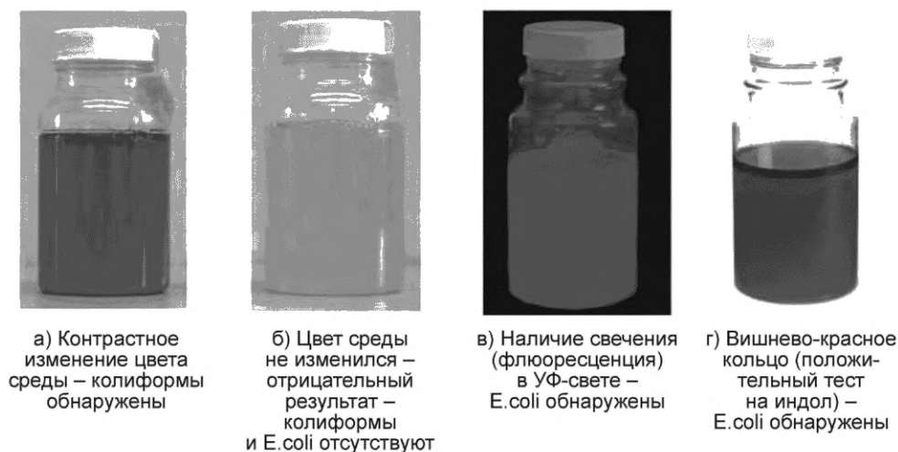
Рисунок 1 — Изменение цвета среды Readycult Coliforms 100 или с аналогичными характеристиками при определении наличия/отсутствия колиформных бактерий и E.coli в 100 см 3 воды
