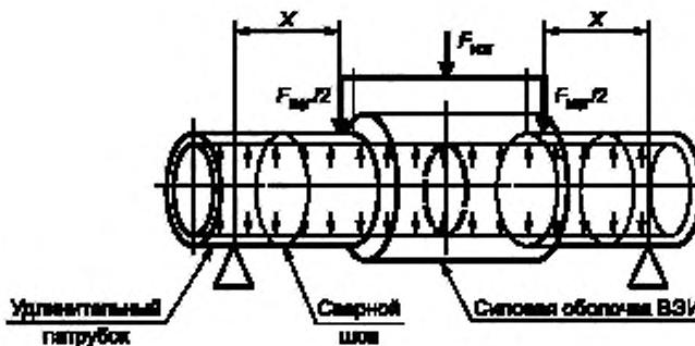
Рисунок 1 — Схема испытания при четырехточечном изгибе
