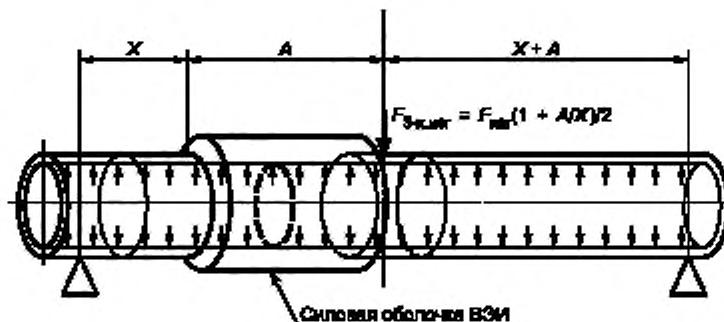
Рисунок 2 — Схема испытания при трехточечном изгибе
