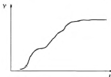
е) Вид процесса проникновения, который имеет место при сильном набухании
