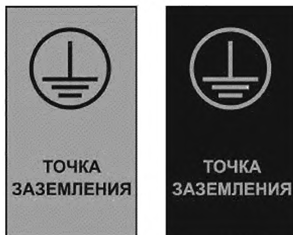
Рисунок 5 — Пример этикетки для МКСМ типа C, обозначающей точку заземления
