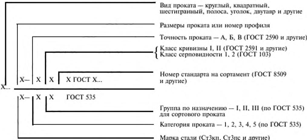
Прокат горячекатанный круглый диаметром 30 мм обычной точности прокатки (В), II класса кривизны, по ГОСТ 2590 марки Ст3сп, категории I, группы II:
