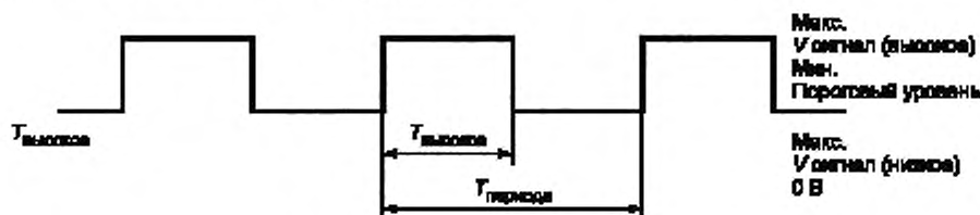
Рисунок Е.5а — Типичный ШИМ-сигнал
