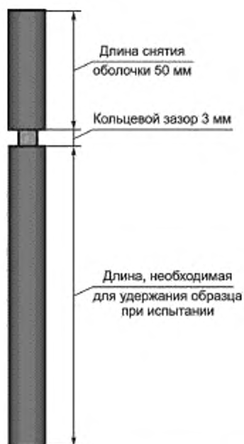
Рисунок 30 — Разделка испытуемого образца ОК
