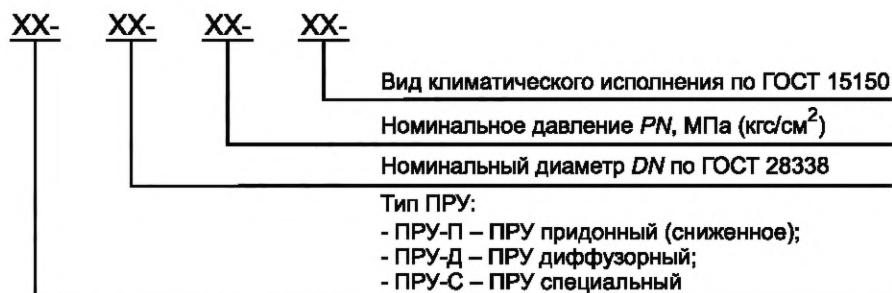
Рисунок 1 — Схема условного обозначения приемо-раздаточного устройства
