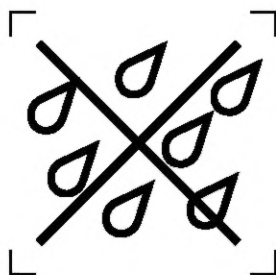
Рисунок 5 — СД-лампа, предназначенная для эксплуатации в сухих условиях или в светильнике, обеспечивающем защиту
