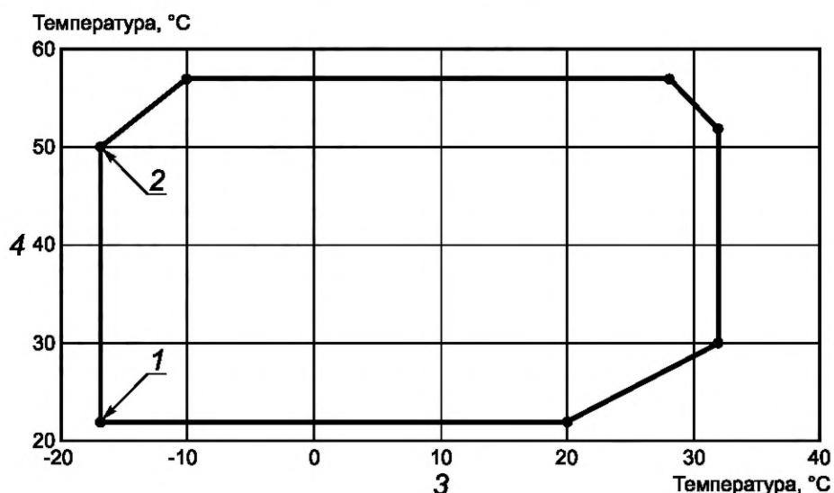
1, 2 — точки испытаний; 3 — температура на входе в наружный теплообменник (°C);
