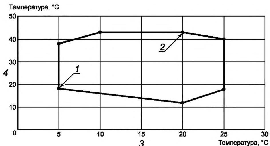
1, 2 — точки испытаний; 3 — температура на выходе из внутреннего теплообменника (°C);
