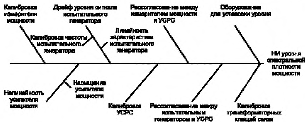
Рисунок А.1 — Примеры влияний на испытательный уровень спектральной плотности мощности при использовании УСРС
