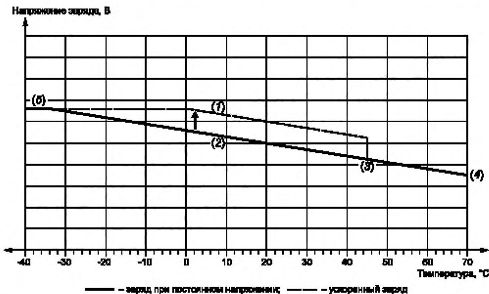
Примечание — На рисунке показан заряд с температурной компенсацией 3 мВ°С/аккумулятор, основанной на 20 °С для заряда никель-кадмийевых батарей при постоянном напряжении (один или два уровня) с ограничением значения тока.
