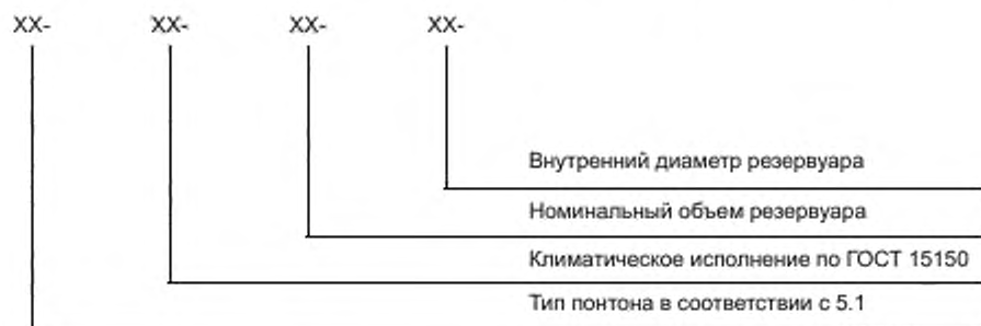
Рисунок 1 — Схема условного обозначения понтона
