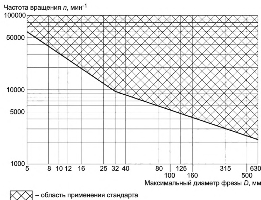
Рисунок 1 — Частота вращения n в зависимости от максимального диаметра фрезы D
