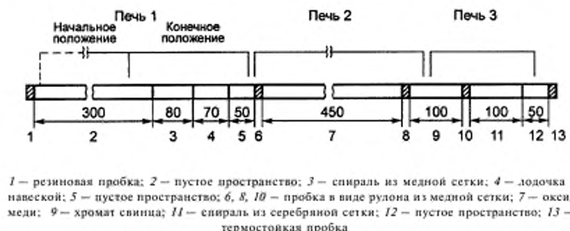
Рисунок 5 — Распределение участков в трубке для сжигания
