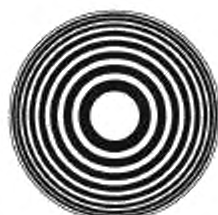
Рисунок 2 — Схематическое представление зонной пластинки Френеля
