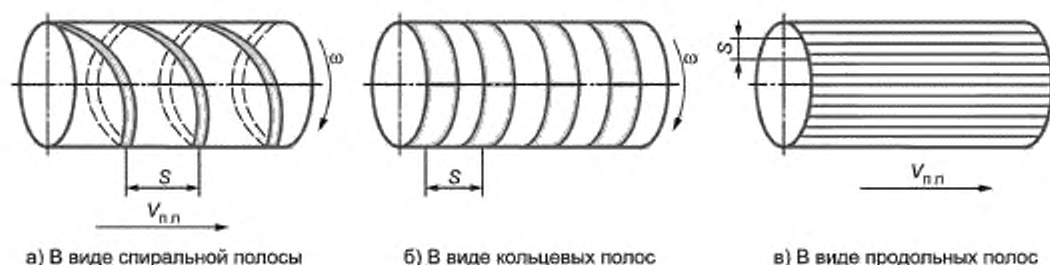
Рисунок 3 — Триботехнические рисунки лазерного термоупрочнения цилиндрической поверхности
