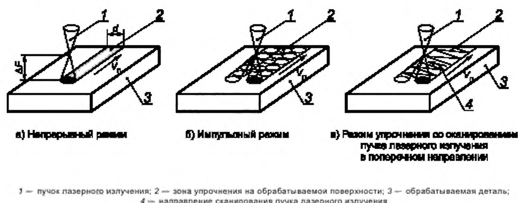
Рисунок 6 — Схемы проведения процесса при различных режимах работы лазера
