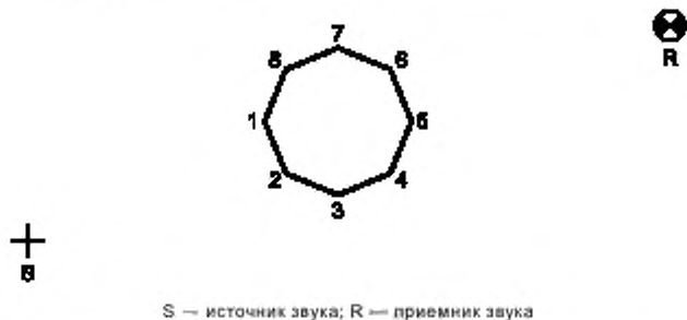
Рисунок 16 — Экранирующее здание призматической формы между источником и приемником, расположенным на малой высоте
