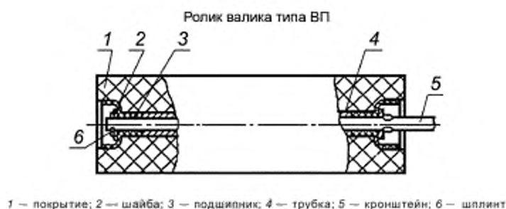
Рисунок А.3 — Ролик валика типа ВП
