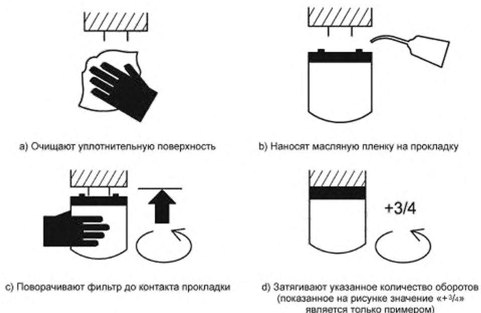
Рисунок 6 — Установка и последовательность закручивания фильтра
