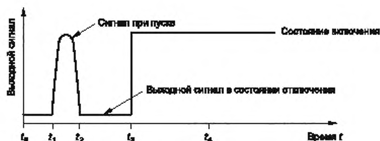
а) Коммутационный элемент в состоянии включения
