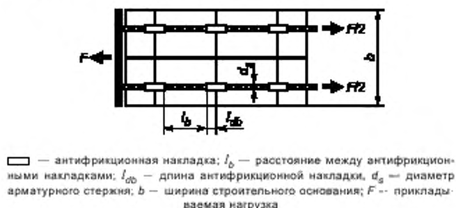
Рисунок 7.1 — Пример строительного основания с установленными антифрикционными накладками на арматуре
