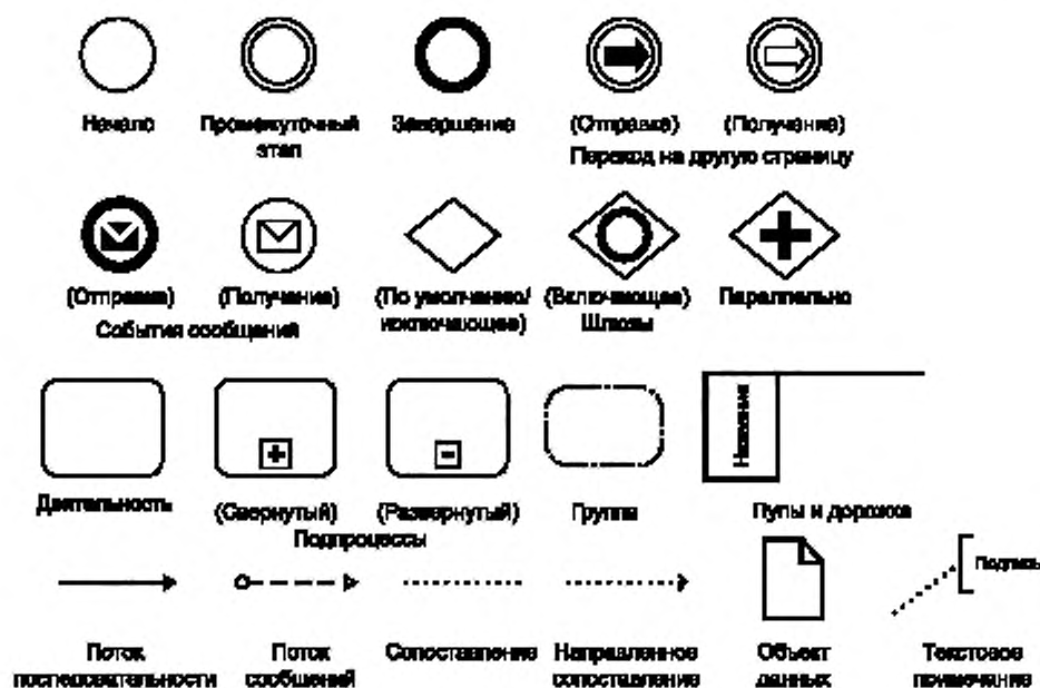
Рисунок D.1 — Рекомендуемое подмножество символов BPMN для разработки технологической карты
