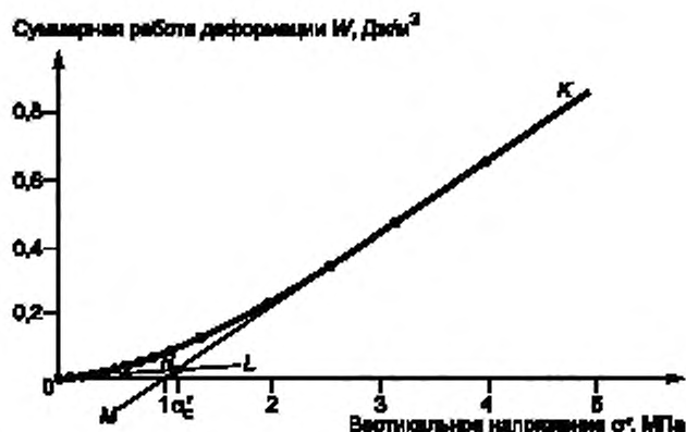
K — кривая зависимости суммарной работы на единицу объема от напряжения, L — касательная линия к начальному линейному участку кривой K , M — касательная ко второму линейному участку кривой K , N — точка пересечения касательных линий L и M , соответствующая давлению предуплотнения
