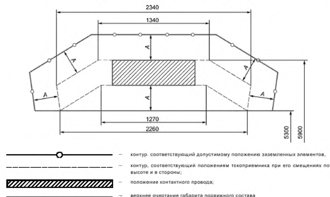
Рисунок 1 — Расстояния между сооружениями, устройствами контактной сети, токоприемниками и подвижным составом
