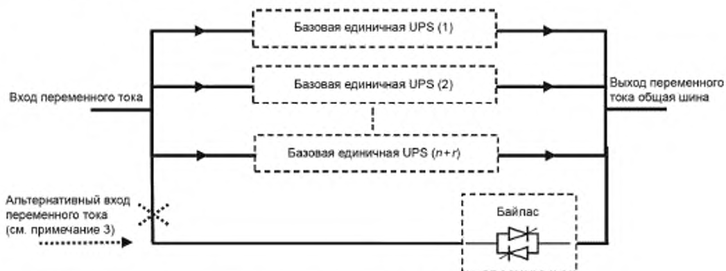
Рисунок A.3 — Параллельная UPS с общим байпас
