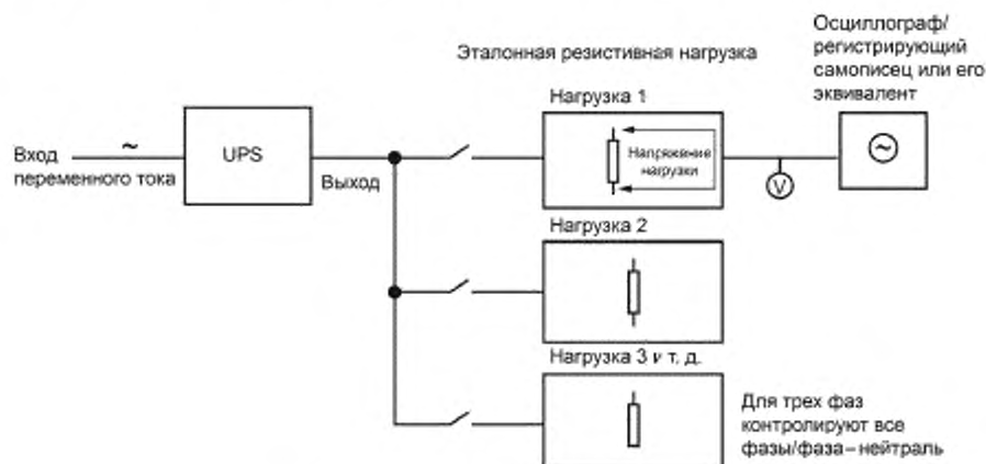
Рисунок 5 — Метод испытаний линейной нагрузки
