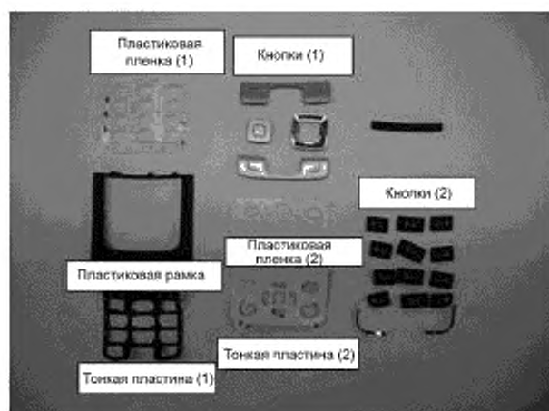
Рисунок Е.4 — Полная разборка клавиатуры
