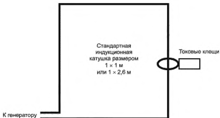
Рисунок 4 — Калибровка стандартной катушки
