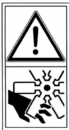
Рисунок С.4 – «Повреждение пальцев или кистей рук – вентилятор двигателя»
