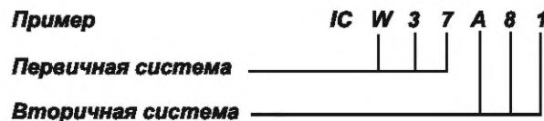
Настоящий стандарт предусматривает более упрощенное обозначение путем исключения буквы A и характеристической цифры 7 в обозначении вторичной цепи циркуляции хладагента при определенных условиях.
