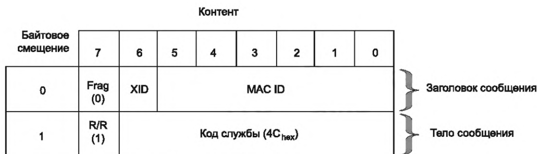
Рисунок 11 — Формат отклика на отключение соединения
