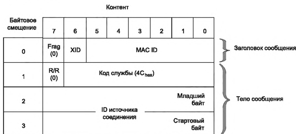
Рисунок 10 — Формат запроса на отключение соединения
