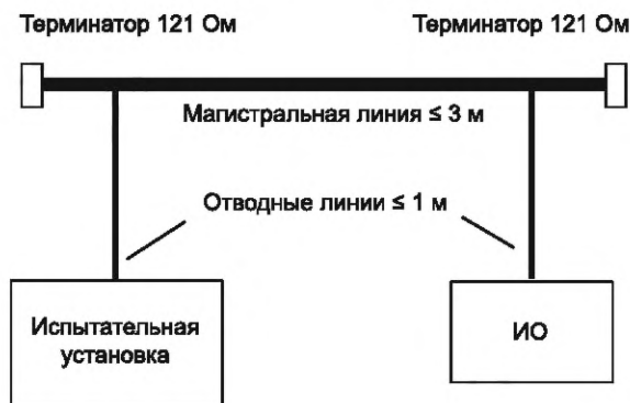
Рисунок 73 — Испытательная цепь для логических испытаний
