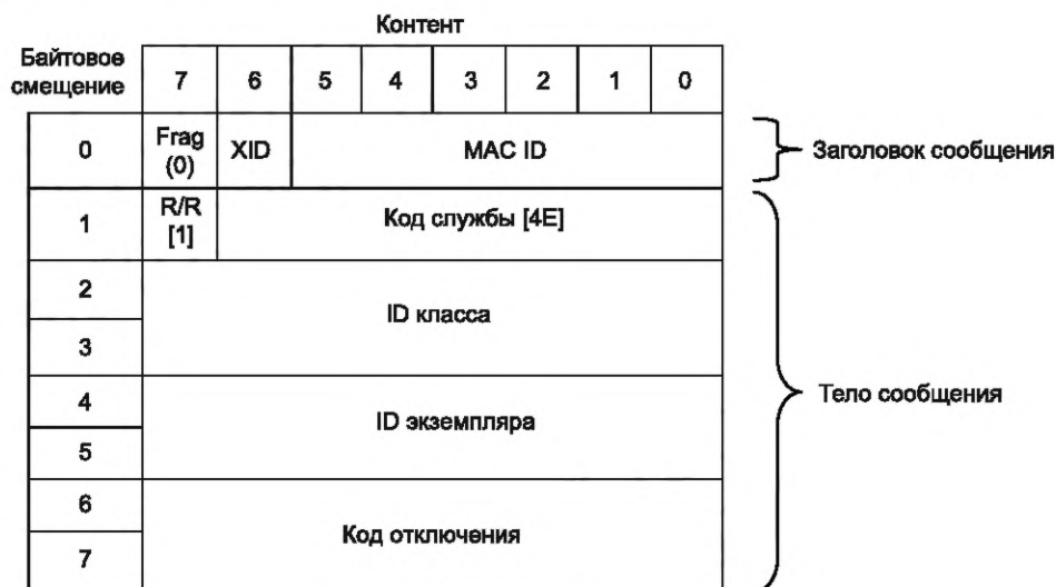
Рисунок 34 — Сообщение об отключении устройства
