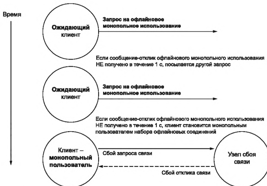
Рисунок 21 — Установление офлайнного монопольного использования
