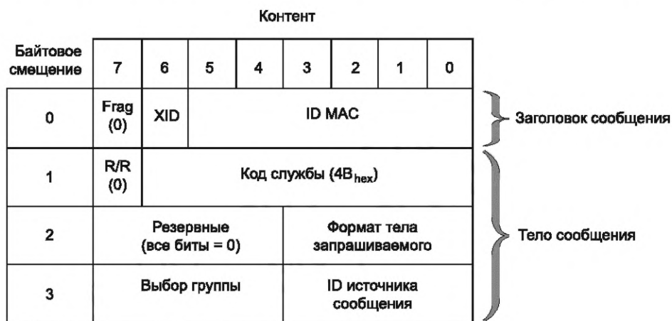
Рисунок 8 — Формат запроса на открытое соединение для передачи явных сообщений
