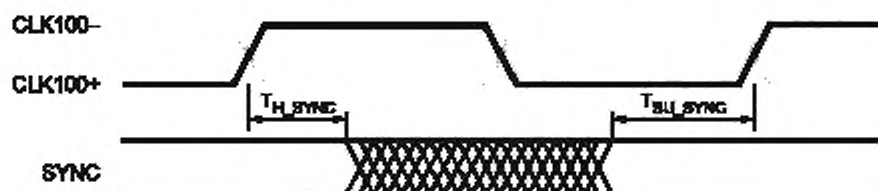
Рисунок 6.5 — Синхронный режим сигнала SYNC
