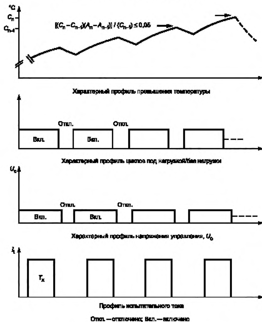
Рисунок F.1 — Профиль испытания на тепловую стабильность
