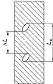
Подверженная пористость длины сварного шва  $L_c$  при покализованной пористости.
