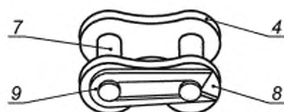
г — соединительное звено с пружинным замком
