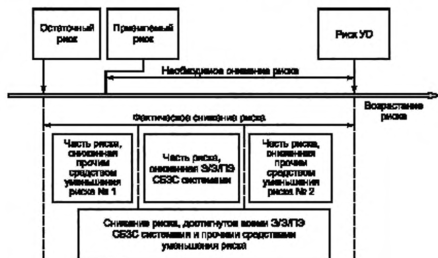
Рисунок Д.1 — Обобщенная модель снижения риска (режим с низкой частотой запросов)
