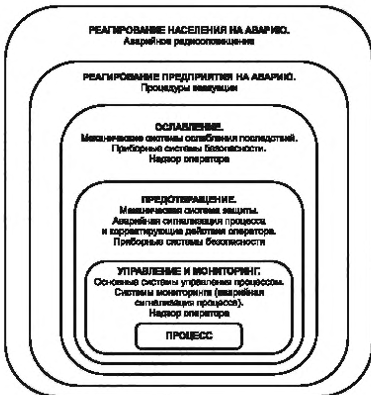
Рисунок 9 — Типовые слои защиты и средства снижения риска
