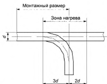
Рисунок 1 — Зона нагрева трубы для выполнения гибки под углом 90°
