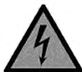
Осторожно: Электричество ИСО 7010 - W012
