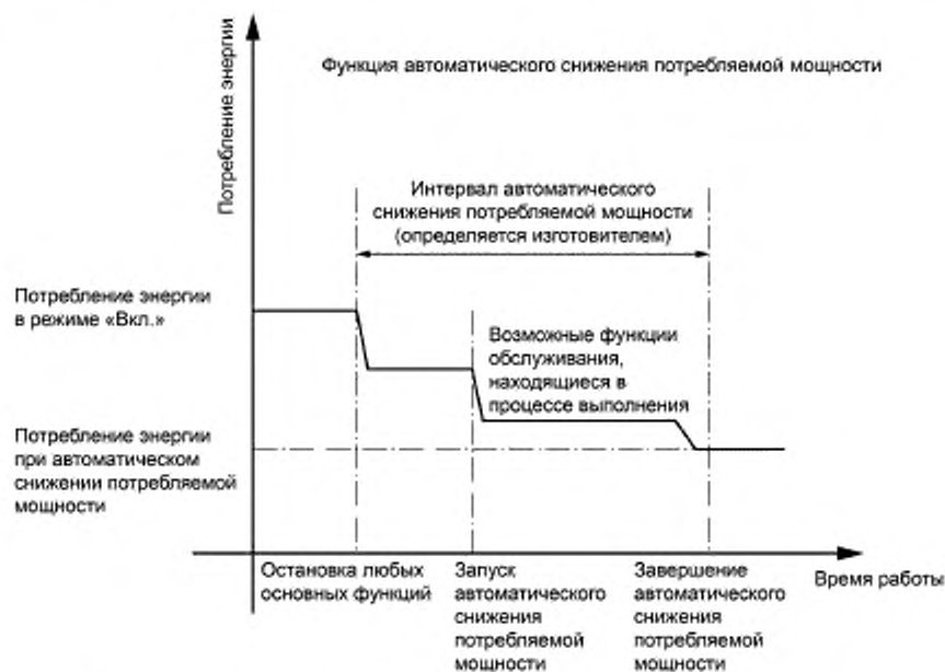
Рисунок 1 — Функция автоматического снижения потребляемой мощности
