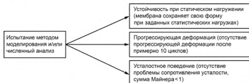
Рисунок 2 — Технологическая схема расчета для мембран
