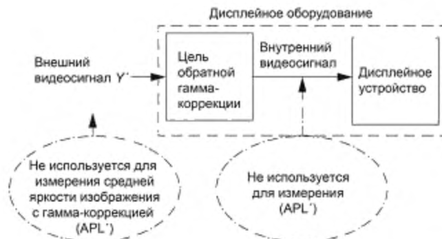
Рисунок 1 — Средний уровень сигнала яркости изображения с гамма-коррекцией (APL')
