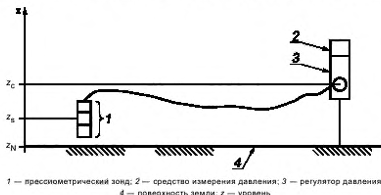
Рисунок В.3 — Положение зонда и регулятора давления во время проверки на потерю давления
