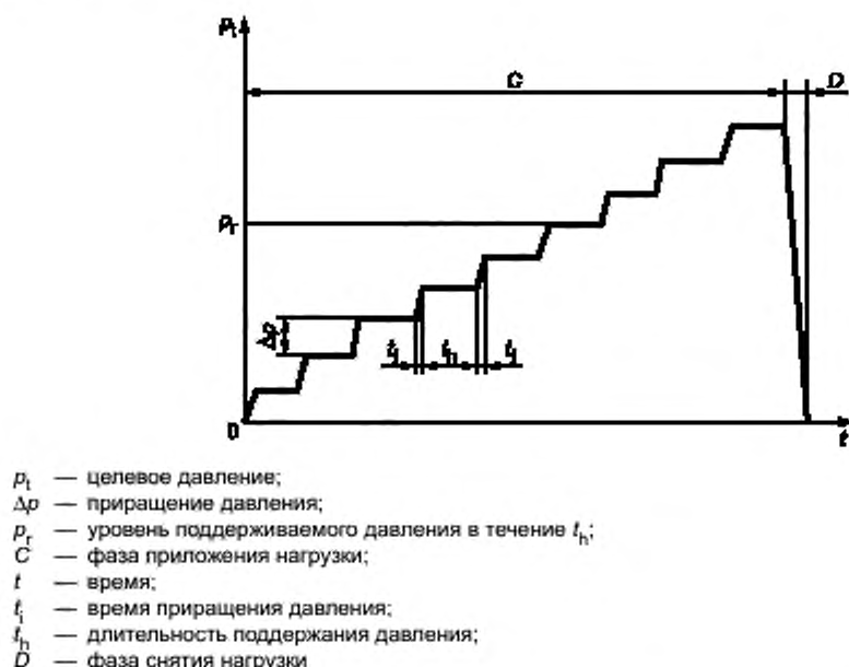
Рисунок 4 — Программа приложения нагрузки для прессиометрического испытания по Менарду
