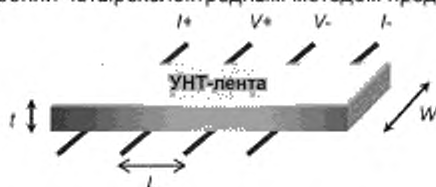
Рисунок 4 — Схема проведения измерений четырехэлектродным методом
