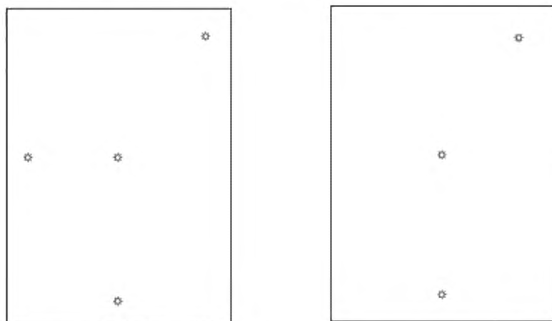
Рисунок 3 — Размещение точек измерения температуры на фотоэлектрическом модуле
