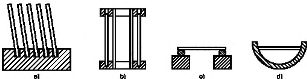
a) огнеупорный блок с отверстиями соответствующего размера, подходящий для испытаний в муфельной печи;
