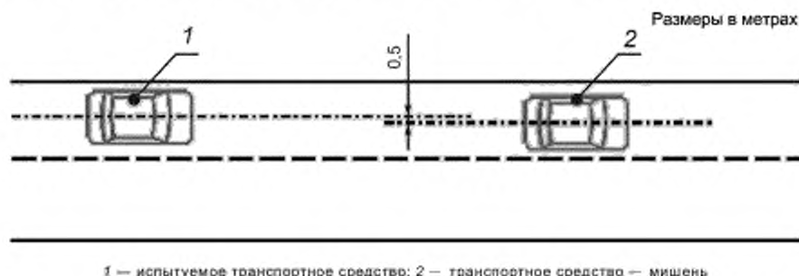
Рисунок 11 — Испытание возможностей автоматической остановки (начальные условия)
